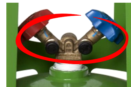
Valvola a Y bifase (Gas+Liquido) uscita doppia 1/4" SAE Flare- 7/16" 20 UNF + Valvola di Sicurezza
