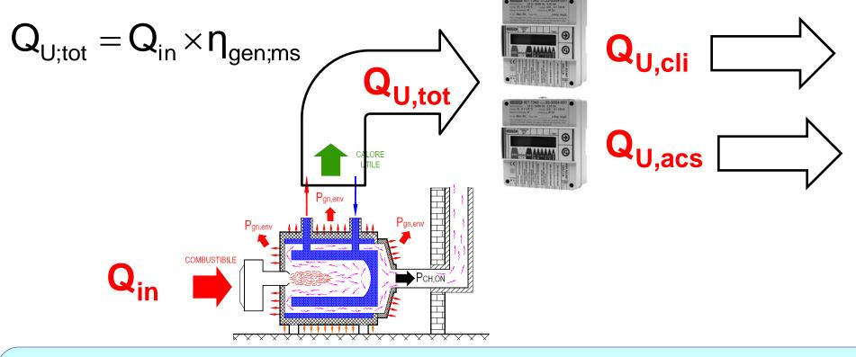
Se c'è anche acqua calda sanitaria è <u>caldamente raccomandato</u> aggiungere un contacalorie anche sul primario dello scambiatore del produttore di acqua calda sanitaria per determinare la quota di energia utile per riscaldamento e per acqua calda sanitaria.
